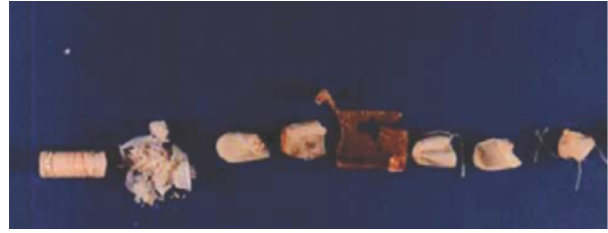
Abb. 6: Schichten von aussen nach innen: Wachs (1), Gummifingerling (2+3+4), Klebeband (5), Gummifingerling (6+7) und Papier (8); (Reihenfolge Bild und Aufzählung ist nicht übereinstimmend, aber alle Materialien werden abgebildet)
